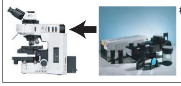
構成:顕微鏡の投光管に取り付けます。 観察用光源はマイクロポイントに取 付可能で、観察とマーキングが同時 に行えます。
